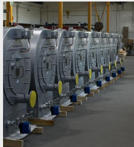
Abb.12: Gasbrenner von RAY-Egelhof für das LNG-Terminal in Brunsbüttel
