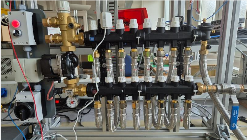
图8: FTV 热电控制阀在供暖回路分水器中的应用
